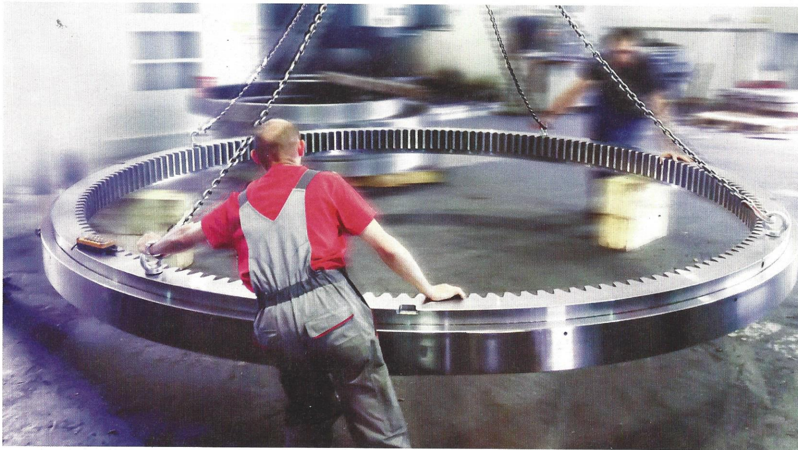
Nach über 50 Jahren im Dauerbetrieb musste im Braunkohletagebau Garzweiler beim Absetzer 743 unter anderem eine gigantische Kugeldrehverbindung ersetzt werden. Bilder: Rodriguez
