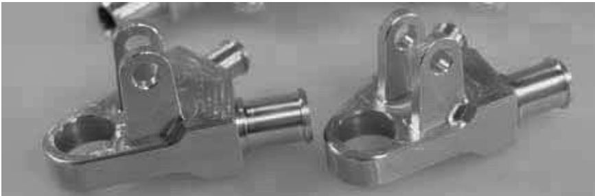
Bild 2: It's Greenteam-Time: Für das Rennteam der Uni Stuttgart fräste der Prototypenbauer die Radträger aus einer Aluminiumlegierung
