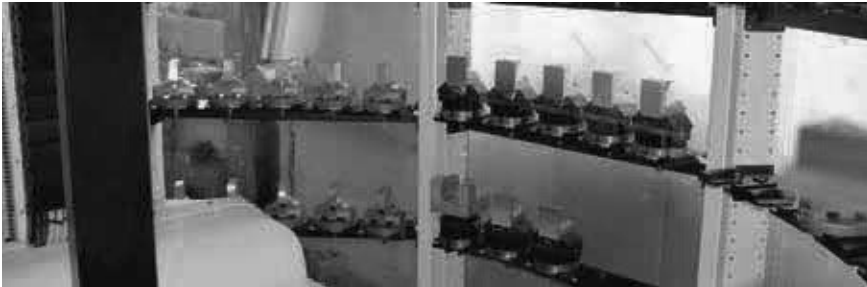
Bild 4: Automatisch mit Nullspannsystem gewechselt: Der Prototypenbauer setzt als einer der wenigen in der Branche auf eine Roboterzelle mit Palettenwechsler für die Bauteilzuführung
