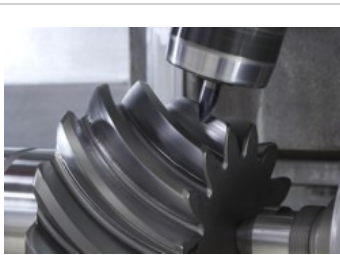
Bild 4: Die Integration der Verzahnstechnologie aus Chemnitz trägt neue Früchte: Gezeigt werden Wälzfräsmaschinen inklusive Anfas- und Entgrattechnik, die VDM 1000 TM für das Verzahn von Ritzeln, Wellen und Rotoren sowie das Cyclo-Paloid-Fräsen von Wellenteilen auf dem horizontalen Dreh-Fräszentrum VDF 450 TM.
