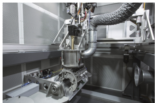
(Abb. 5 Beschichtungskabine der Sturm ACCS TWS Anlage)
